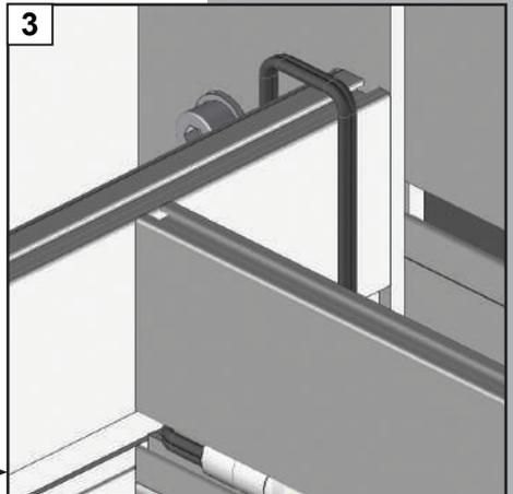
3 Remonter le câble jusqu'au coffre arrière.
